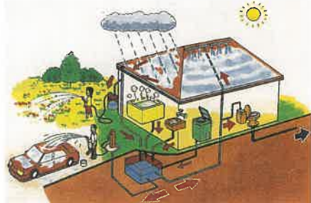
家庭用の排水再利用システムの導入により、お風呂の残り水や洗濯水を処理してトイレや散水などに利用しています。
