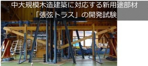
中大規模木造建築に対応する新用途部材「張弦トラス」の開発試験
