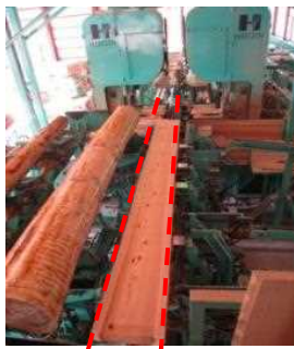
<高性能製材機械> ツインバンドソー ツイン丸鋸ソー ブロック製材機
