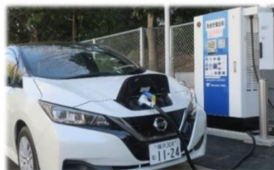
電気自動車（EV）及び急速充電器
