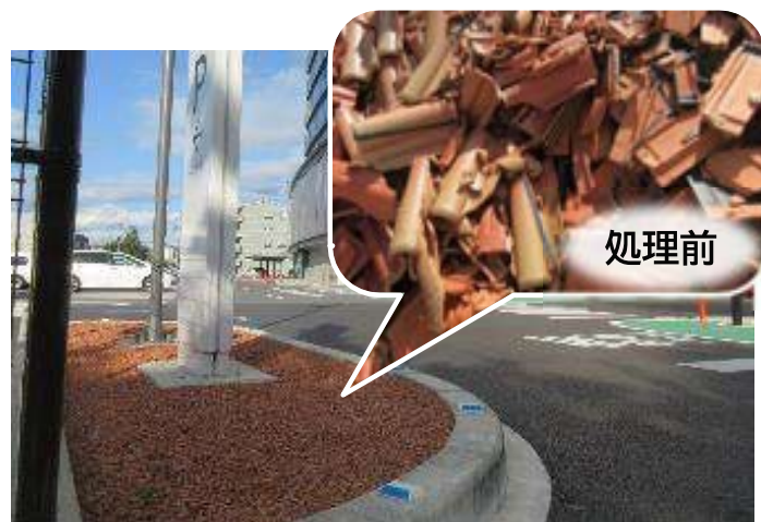
廃瓦を破碎処理して化粧材として再利用
