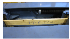
引張試験状況写真
