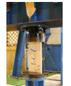
圧縮試験 状況写真
