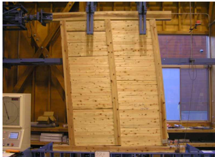
スギ柱と圧縮強度の強いヒノキ面材により構成された耐力壁の面内せん断性能試験状況（栃木県林業センター）
