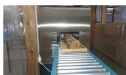
きのこ原木用放射能の非破壊検査測定機 古河機械金属㈱社製ガンマスポッター FG5F-TF (GAMMA RADIATION DETECTOR FG5F-TF)
