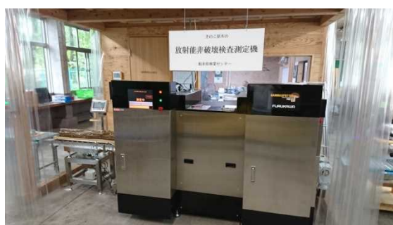
きのこ原木用放射能の非破壊検査測定機 古河機械金属㈱社製ガンマスポッター FG5F-TF (GAMMA RADIATION DETECTOR FG5F-TF)
