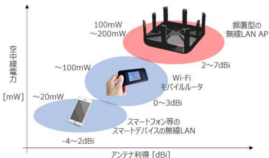
図 27 無線 LAN 機器の電波の強さのイメージ例 (2.4GHz 帯, 20MHz 幅)
