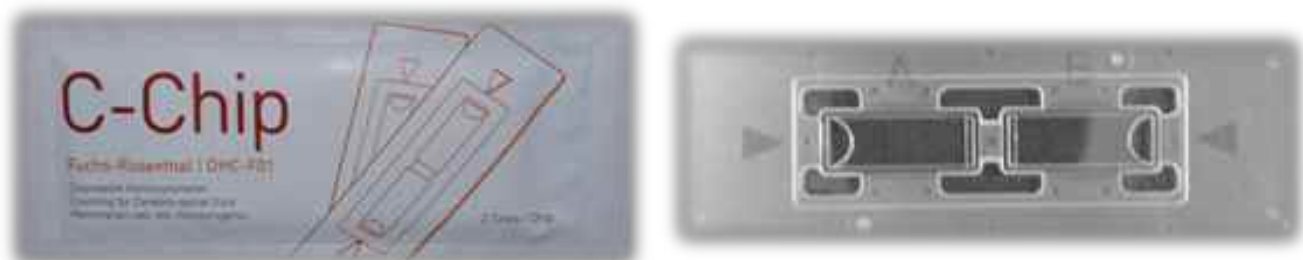
図 2 使い捨ての Fuchs-Rosenthal 計算盤。カバーガラスをかける手間も不要で、ケガをするリスクは少ない。廃棄も容易である。
