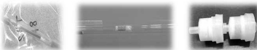
捕集管: 右から酸化エチレン用、水銀用、アルデヒド類用
