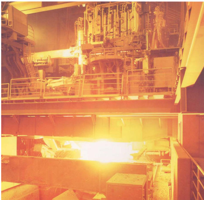
電気炉での出鋼
