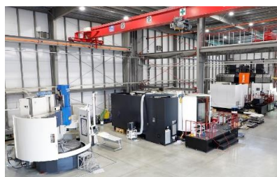
左:ターニング 中:複合機 右:5軸5面加工機
