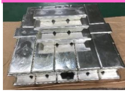
はんだ内部の酸化物を除去したはんだインゴット
