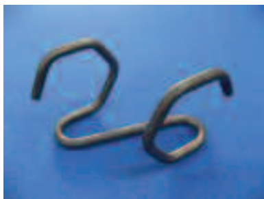
チタンパイプ曲げ
