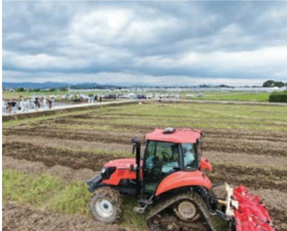
トラクタによる自動操舵試験走行
