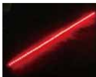
栃木県農業試験場と県内企業で共同開発した電照菊栽培用のLED照明（赤く光る棒状LED）
