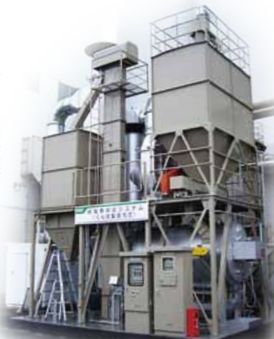
施設用籾殻燃料燃焼炉（右） 個人用籾殻燃料穀物乾燥機（左）
