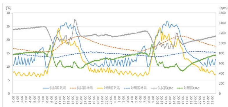
図1 気温、地温、炭酸ガス濃度の推移（1/1～1/2）
