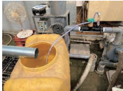
液肥混入器を利用した 低濃度エタノール投入
