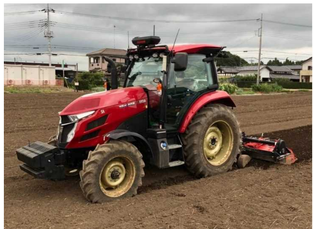
ロボットトラクタによる耕うん作業
