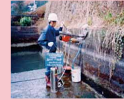
コア採取による強度測定
