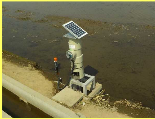
水位などを測るセンサーがついた給水バルブ
