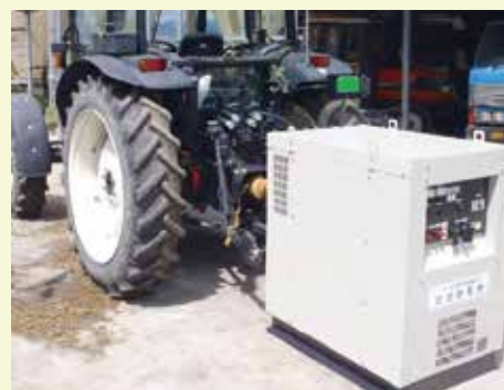
トラクターのPTOを利用する発電機
