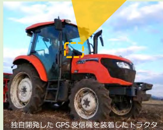
独自開発した GPS 受信機を装着したトラクタ
