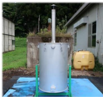
小型機（もみがら用） （処理能力：500L/日、煙が多い）
