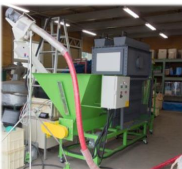
中型機（もみがら用） （処理能力：1500L/日、煙が少ない）
