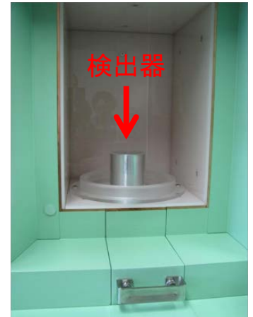
写真3 遮へい体の内部
