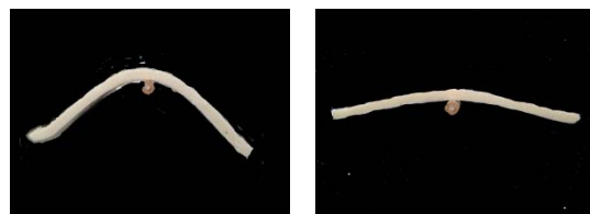
写真 吊り掛け試験による糯米の硬化性検定
