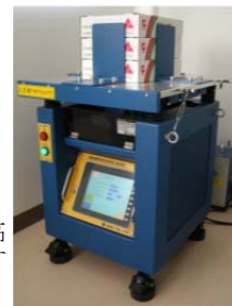
写真 加振装置で果実の損傷程度を調査します。
