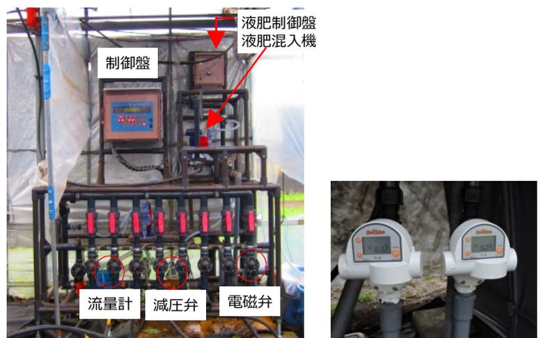
図2 根圏制御栽培用養水分管理装置（左：複合管理制御用装置、右：簡易タイマー）
