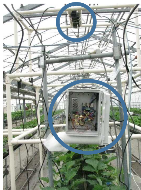
写真 (上部) 3次元形状計測センサ (中央部) 自作したUECSセンサ
