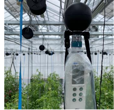
写真1 WBGT計を用いた計測の様子 注 AD-5695DL (A&D) を高さ3.5mに設置し10分間隔で計測。
