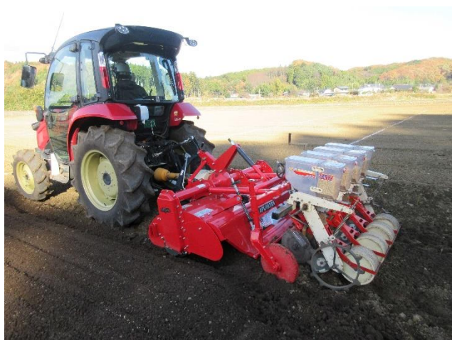
写真1 アッパーローターを用いた 耕うん畦立て同時播種の様子
