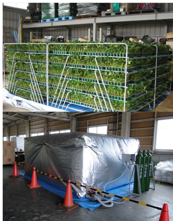
図5-1 ファスナーバックによる高濃度CO 2 処理装置
