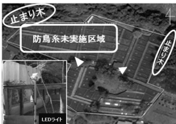
図8 ライトの設置場所及び点灯方向
