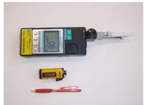
畜環研式ニオイセンサとGPSロガー (下段はボールペン)
