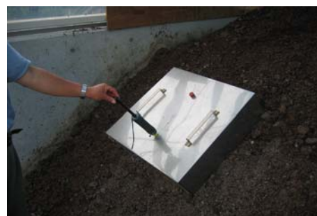
検知管による臭気調査風景
