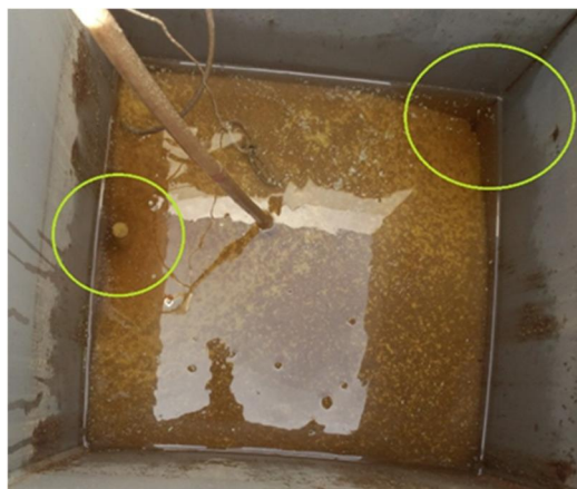
図 3 ノッチタンク試験における短絡流の様子
