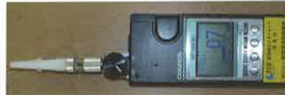
図2 畜環研式ニオイセンサ ・臭気指数相当値が測定できる装置 ・ポータブル (W84×H275×D40mm) ・1カ所 2～3分で測定可能
