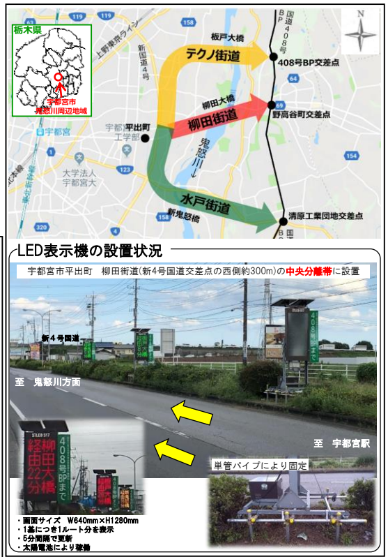
主要渋滞箇所におけるプローブデータの活用によるリアルタイム旅行時間表示システムを用いた実証実験
