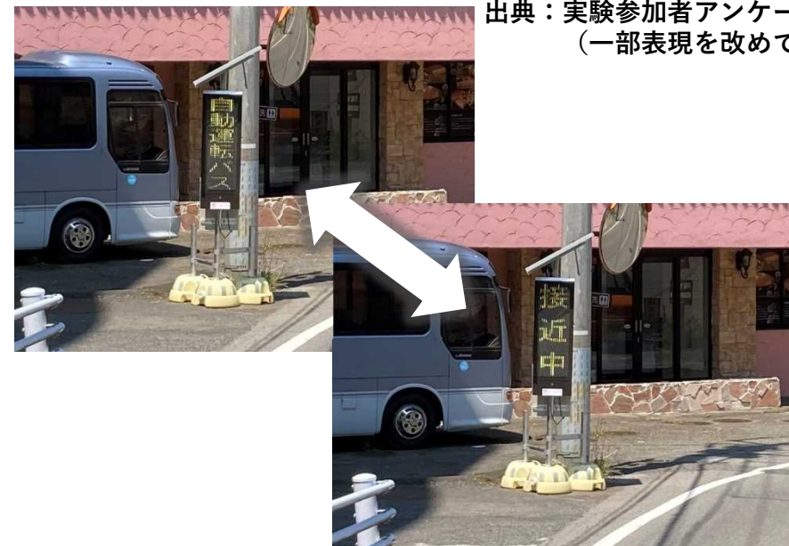
ICT-LED掲示板の作動状況 (対向車線の前方を自動運転バスが走行中)
