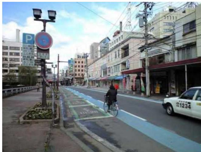
図 3-6 自転車専用通行帯のある道路にパーキング・メーターを設置するイメージ
