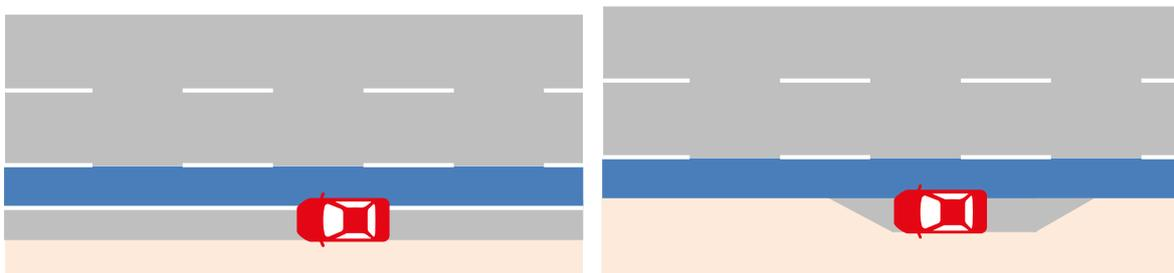
図 3-7 自転車専用通行帯がある場合の自動車アクセス空間の整備手法イメージ
