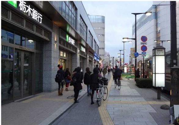
写真 市街地再開発による建物セットバックにより歩行空間を確保した事例（宇都宮市）
