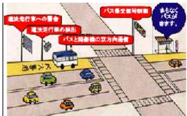
公共車両優先システム（PTPS）のイメージ (出典：国土交通省)
