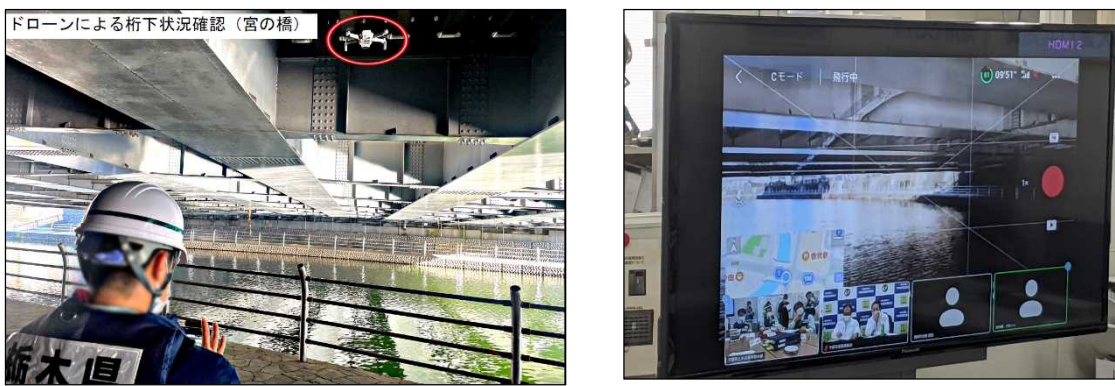
図 3-3-4：ドローン活用による橋梁の被災確認（訓練）
