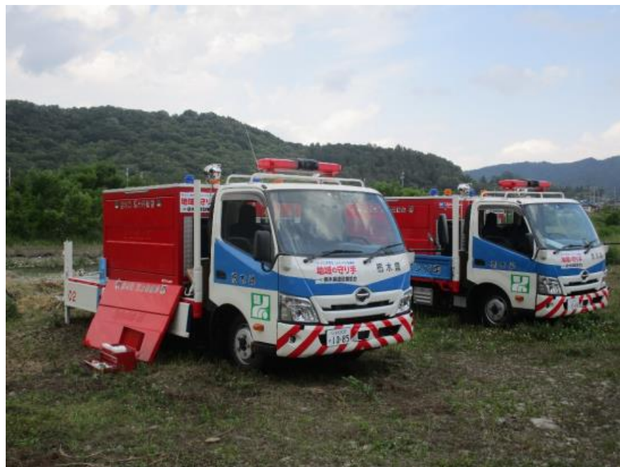
【栃木県排水ポンプ車全景】
