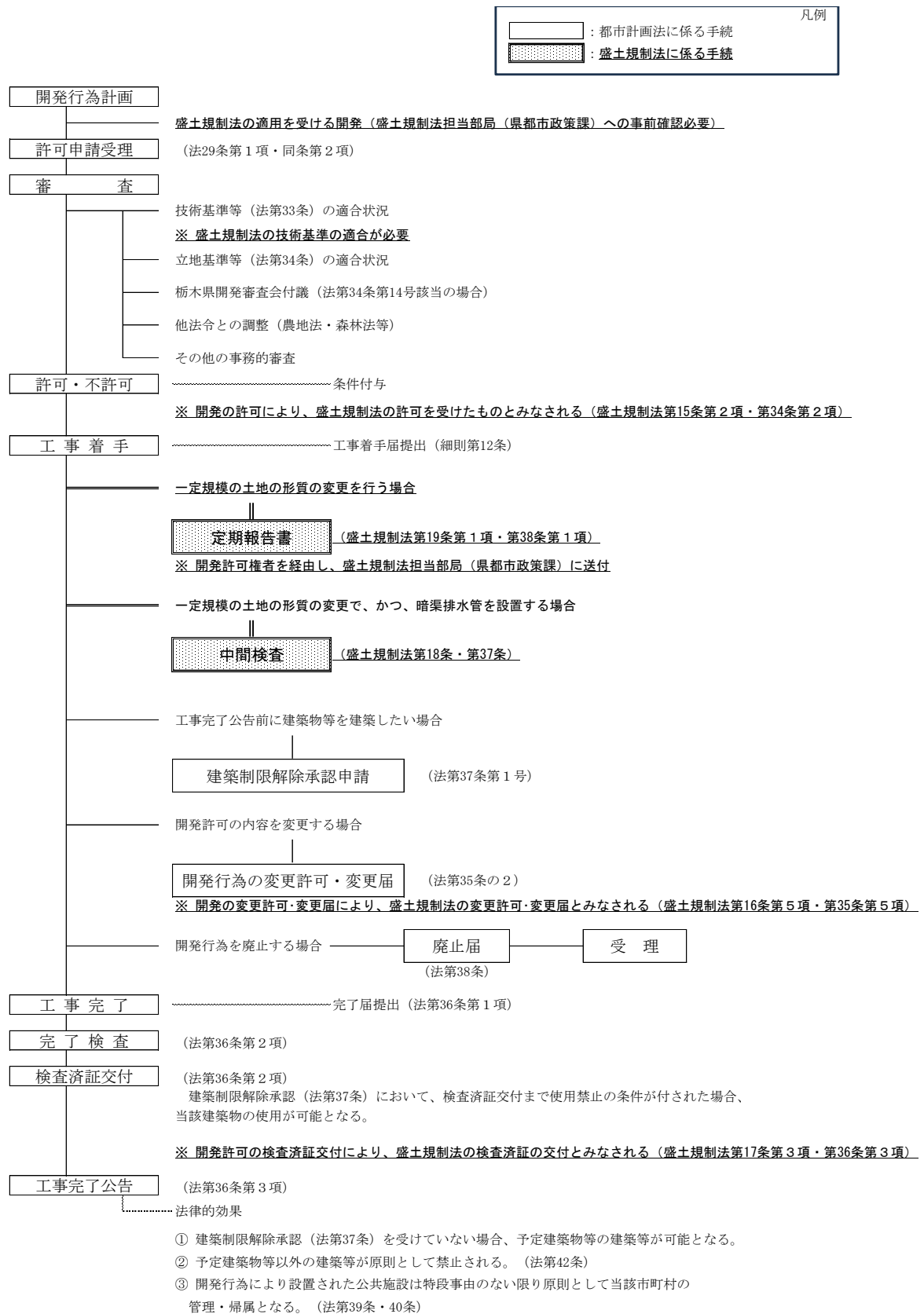
図 1.10 盛土規制法みなし許可の場合の開発許可制度の主な流れ
