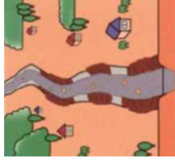
出水により護岸が被災
