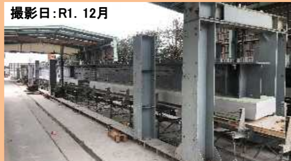
川田建設(株)那須工場 下太田橋 プレビーム桁製作
