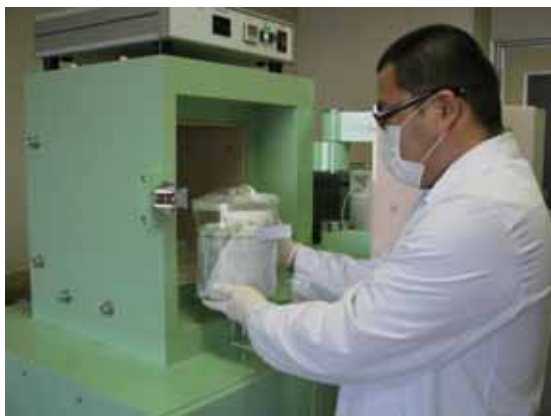
【農業試験場】ゲルマニウム半導体検出器 スペクトロメータ
