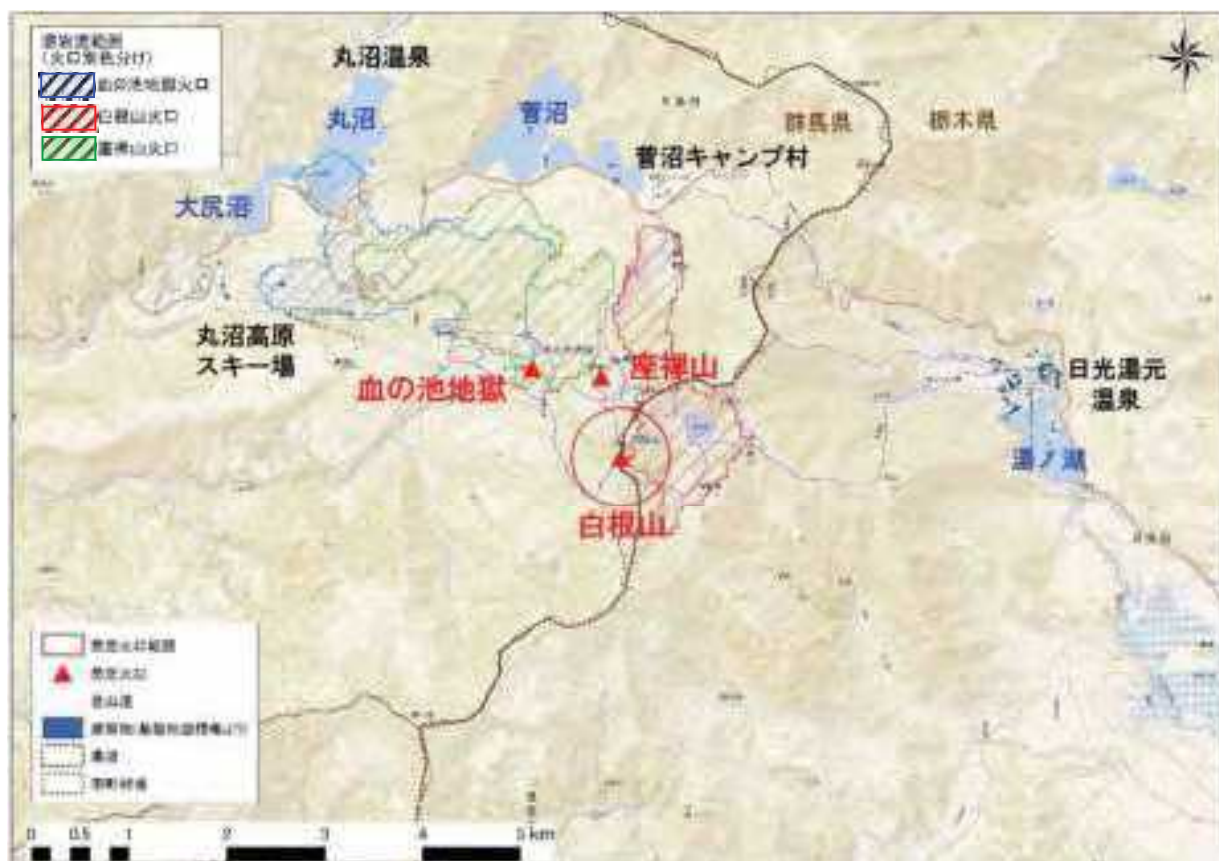
図 3.16 本計画で想定する溶岩流の到達範囲（噴出量1億 \text{m}^3 ）
