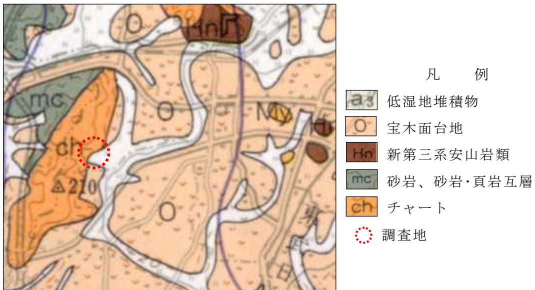
図-3.1 調査地付近の地質図 (20 万分の 1 地質図「宇都宮」；地質調査所)
