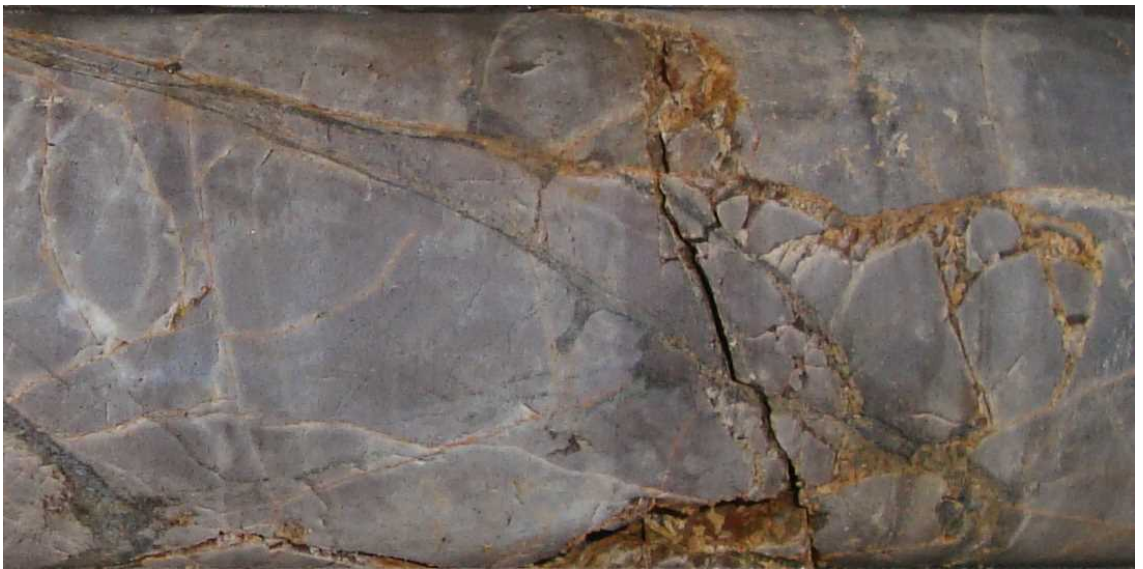
写真④ チャートのボーリングコアの状況
