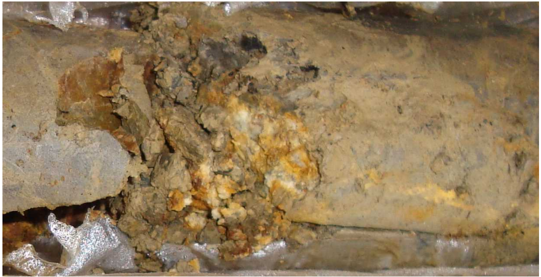
写真① 強風化チャートのボーリングコアの状況
